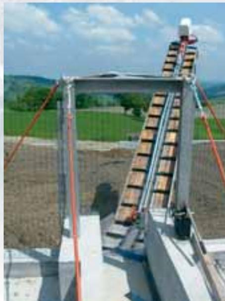
Élévateur à circuit fermé orientable.
